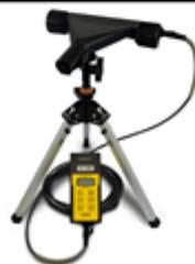
**Método de Avaliação da Opacidade** – consiste em um método que permite determinar a opacidade da fumaça de maneira instrumentada (objetiva), realizado com o veículo parado.
