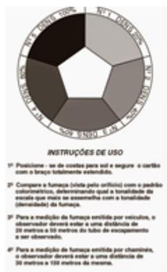
**Método de Ringelmann** – consiste na comparação do grau de enegrecimento da fumaça com um dos padrões colorimétricos da escala de Ringelmann reduzida, realizada com o veículo em movimento.
