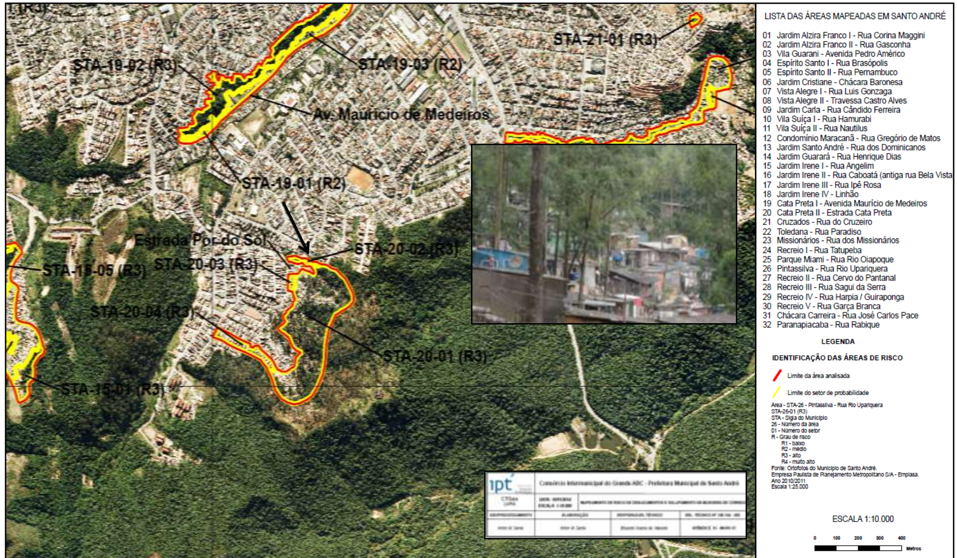
Figura 66: Enquadramento do Núcleo Cata Preta/Eucaliptos como Risco Muito Alto – R3.
