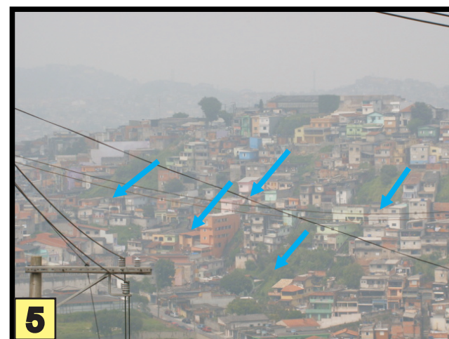
Encosta densamente ocupada por moradias em cortes verticais e aterros lançados, com alta possibilidade de infiltração de água no solo. Histórico de interdições e demolições de moradias em risco de deslizamento.
