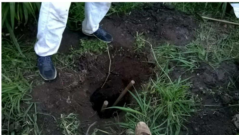
**Foto 4-** Ponto de coleta 02 –Aluviões – amostra 02- Argila areno-siltosa –
