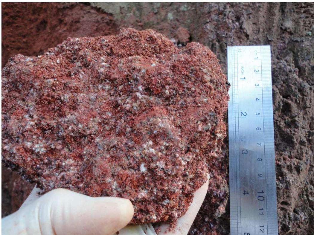
**Foto 11-** Amostra 04 - solo saprolítico residual de alteração de Granitos e Granodioritos - Solo Silte areno-argiloso - Macrofábica: heterogênea e irregular.
