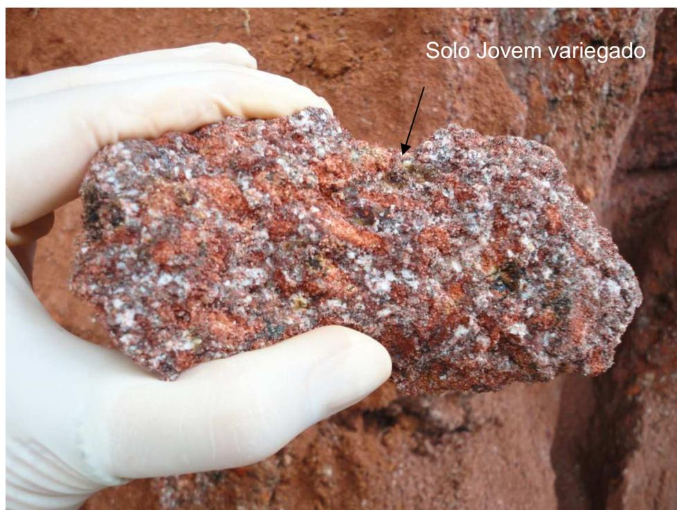
**Foto 10-** Ponto de coleta 4 - Horizonte de alteração de Granitos e Granodioritos, amostra 04 - solo saprolítico residual Silte areno-argiloso - Local:Ribeirão Pires/Estância mineral
