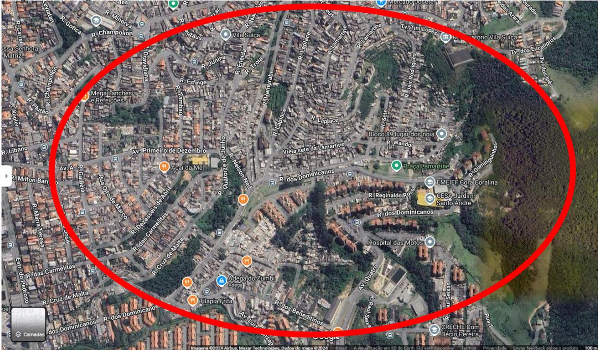
Há áreas de risco alto e risco muito alto para deslizamento e enxurrada. Parte das habitações é em alvenaria e parte em madeira. Há áreas que as habitações foram feitas sobre bermas no talude. Existem poucos dispositivos artificiais de drenagem nessas áreas e alguns estão danificados.
